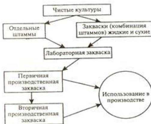
Рис. 1. Схема приготовления заквасок [4]
