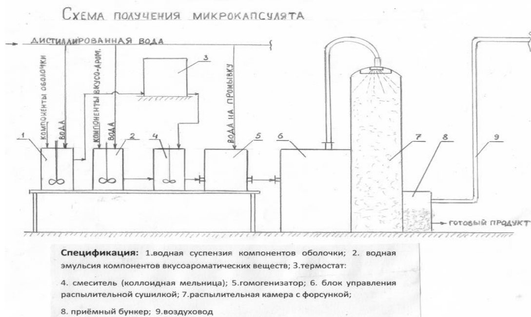
Рис. 2. Аппаратурно-технологическая схема получения микрокапсулята [3]
